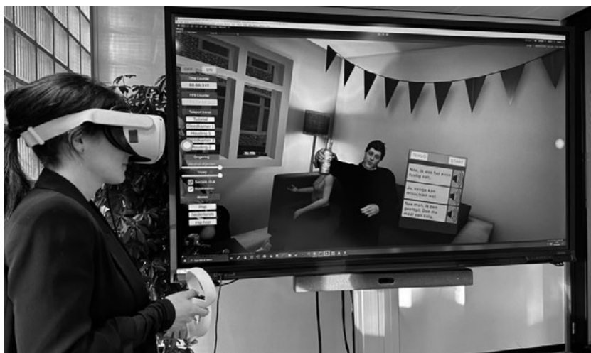
FIGUUR 1 Illustratie van de meekijkfunctie voor therapeuten. De gebruiker draagt de head-mounted display (HMD) om de virtuele realiteit te bekijken. De therapeut kan middels een tweede scherm meekijken naar wat de gebruiker in de HMD ziet.
